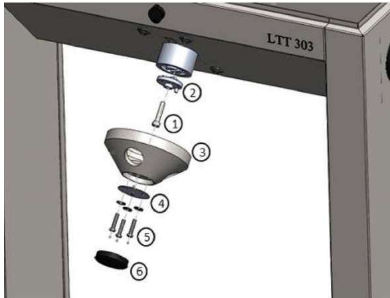
Figura 3.8 Assemblaggio della cabina
